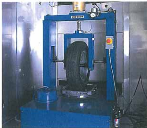
据え切り試験
